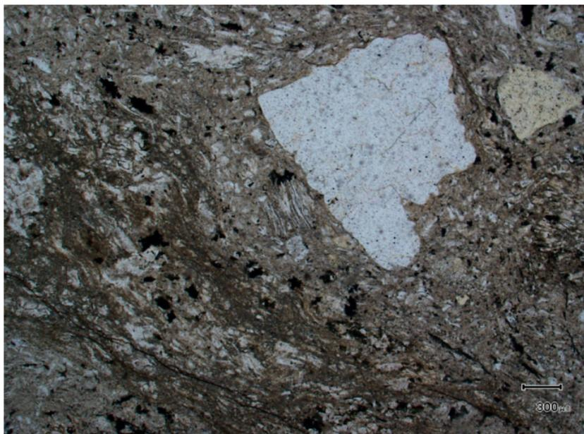
Photo 8 - Quartz polycristallin millimétrique au sein du tuf vitroclastique (Photo 6)
