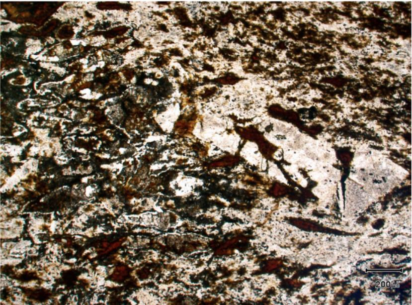
Photo 16 - Vue d'une dacite ignimbritique montrant un phénocristal subautomorphe de plagioclase adjacent à une matrice orientée incluant des « fiammes » oxydées et des plages vacuolaires (en haut à gauche).
