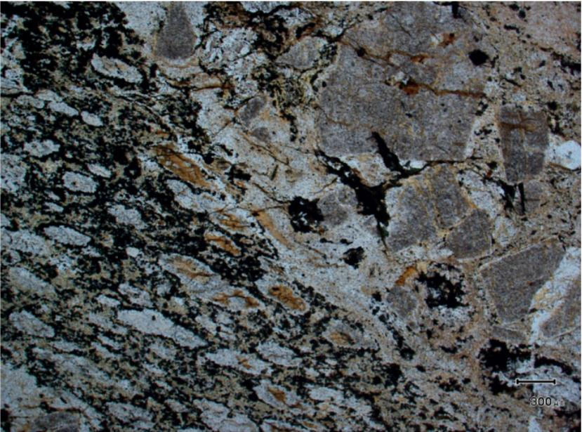
Photo 19 - Brèche rhyolitique montrant la coexistence d'accumulations de cristaux feldspathiques subautomorphe et un fragment de lave vacuolaire piqueté d'oxydes
