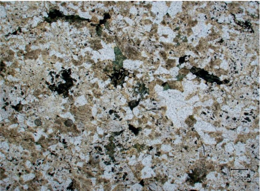
Photo 20 - Vue générale du microgranite à plages micropegmatitiques DVI31, ayant fait l'objet d'une datation géochronologique. Lumière polarisée non analysée
