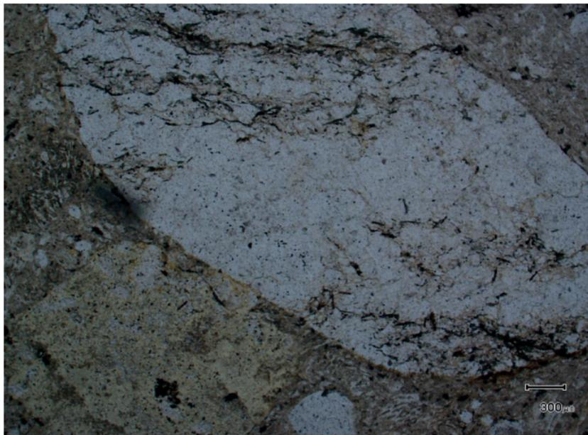
Photo 7 - Galet de quartz polycristallin subcentimétrique au sein du tuf vitroclastique précédent (Photo 6)
