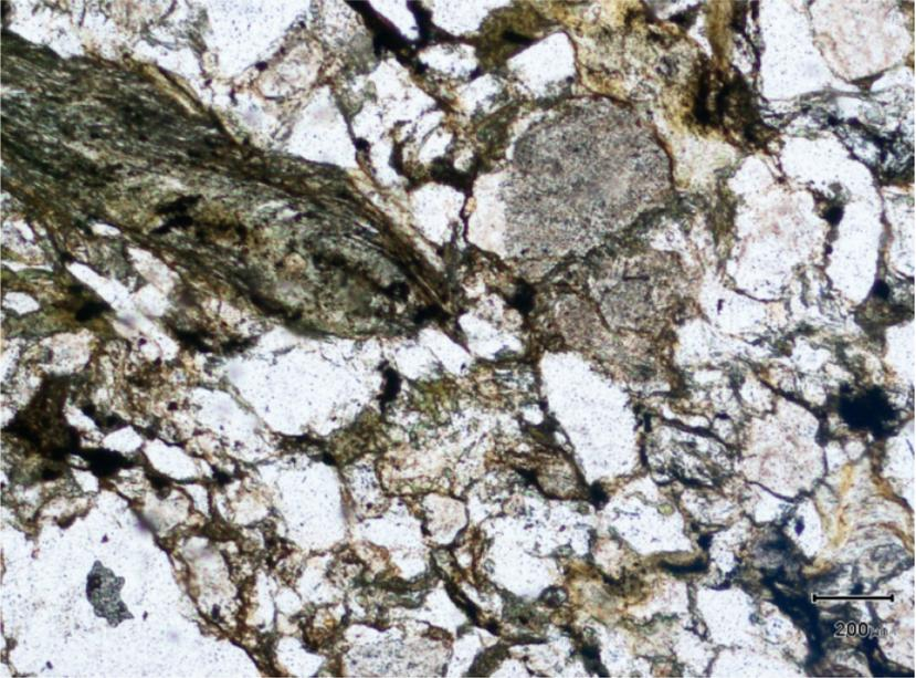
Photo 11 - Vue générale d'un grès grauwackeux à grain assez grossier comportant du quartz dominant, du feldspath subautomorphe, un fragment de schiste chloriteux, des phyllites dispersées (chlorite et mica blanc) et des grains d'oxyde
