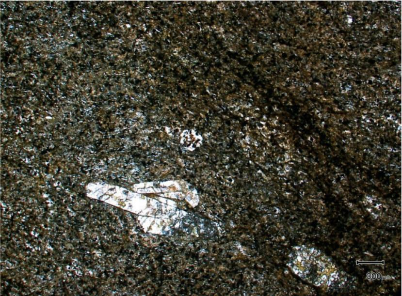
Photo 12 - Vue générale d'une lave basique ou intermédiaire à matrice microlitique riche en chlorite et minéraux opaques (caractère mafique) incluant des plagioclases automorphes. Vers le coin bas – gauche, l'amas ovoïde est une ancienne vacuole comblée par des produits secondaires
