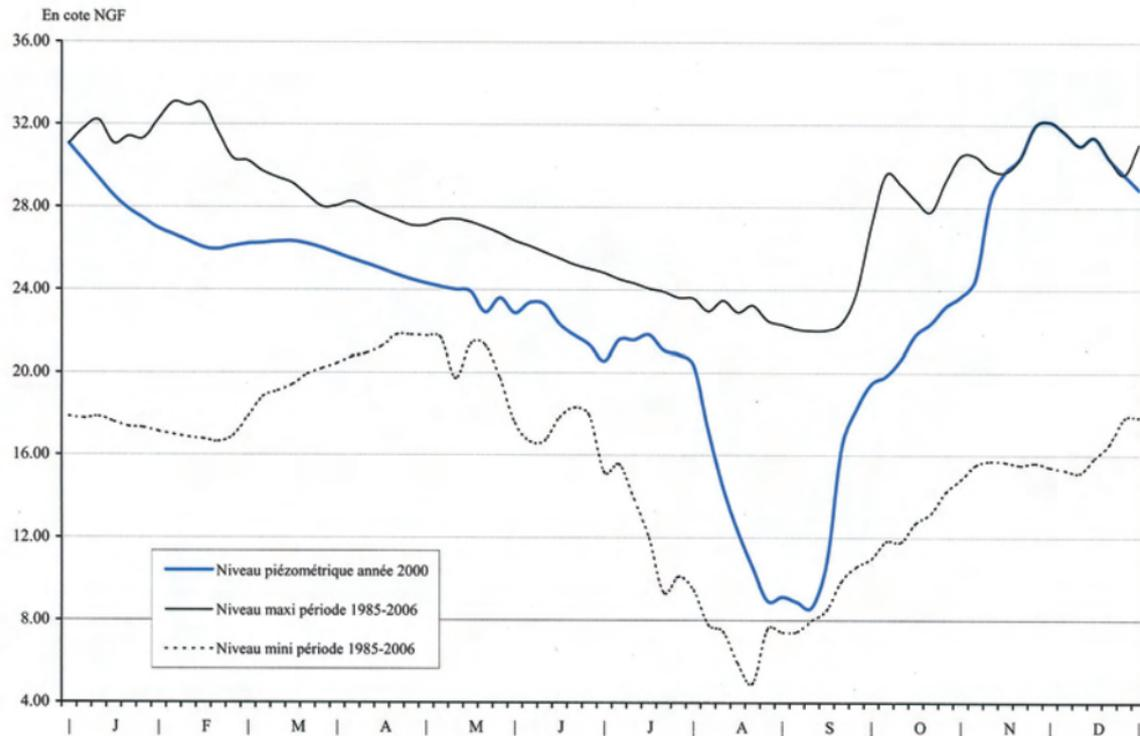
**Fig. 15 - Fluctuations piézométriques à Saint-Étienne-de-Brillouet de la nappe du Lias inférieur - année 2000 (forage indice : 585-5-68)** (Source : Service de l'Eau du Conseil Général de Vendée)
