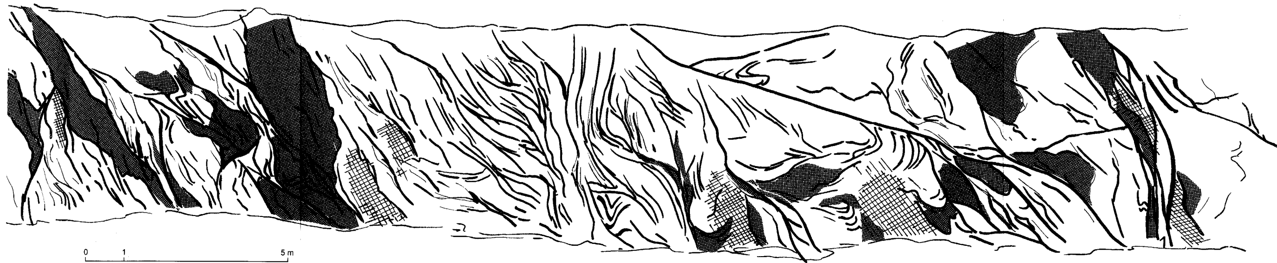
Fig. 9 - Coupe détaillée sur la route de Vaubarlet montrant la dilacération des granites ( en grisé ) et des gneiss ( en blanc ) qu'ils intrudent par des failles inverses, peu inclinées, et par des décrochements (zones broyées verticales : en croisillons )
