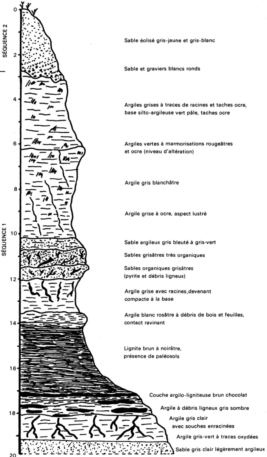
Fig. 2 - Front de taille nord ("Tache C") de l'exploitation d'Arjuzanx (d'après Dubreuilh, 1982)
